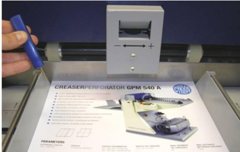
**Image 11 :** Réglage des roues d'alimentation (position 29) à l'aide de la clé Allen T
