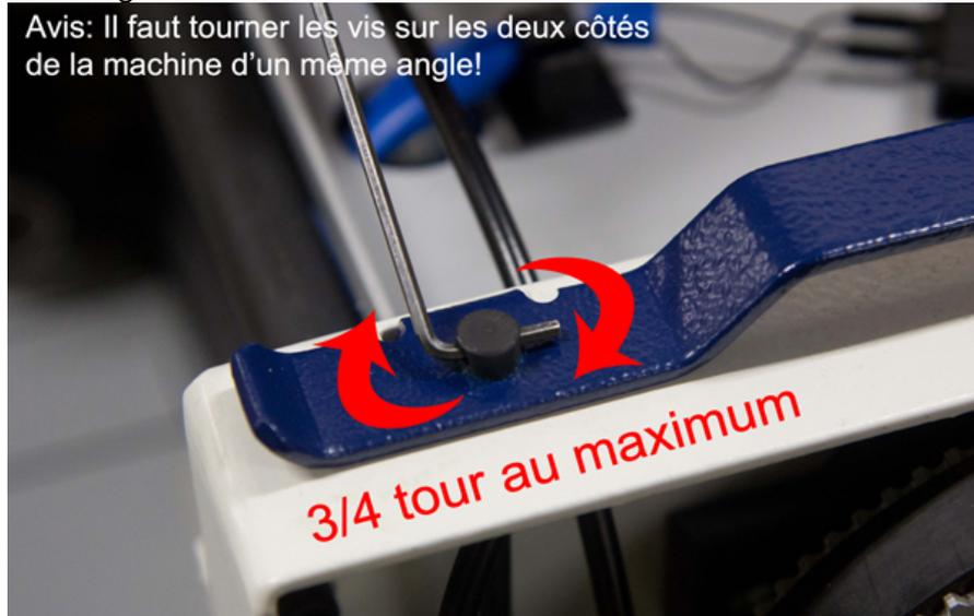
**Image 33:** Lorsqu'on tourne le vis de réglage de rappel du callipers, l'arbre avec les roues d'alimentation se déplace vers le bas et l'écart entre la roue d'alimentation et le séparateur diminue.
