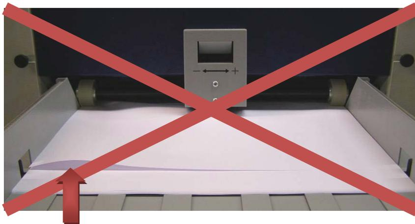
**Image 16 :** Exemple du réglage incorrect de la pression de la table – pression trop grande pour un petit grammage de papier
