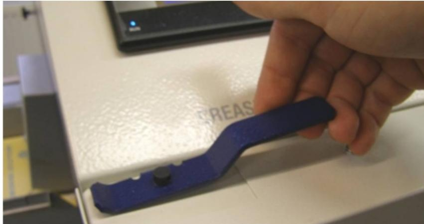
**Image 17 :** Mise du callipers dans sa position supérieure
