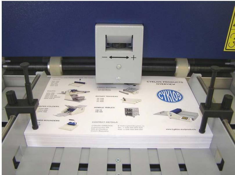
**Image 15 :** Exemple du placement correct d'un tas de papier
