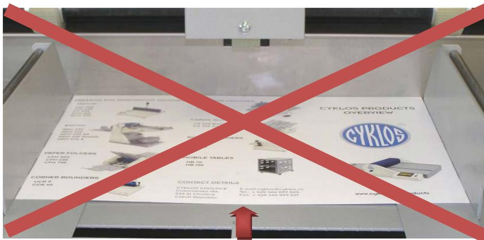
**Image 8 :** Table mal préparée – l'absence des bandes magnétiques de distance (position 5) entraîne la déformation du papier
