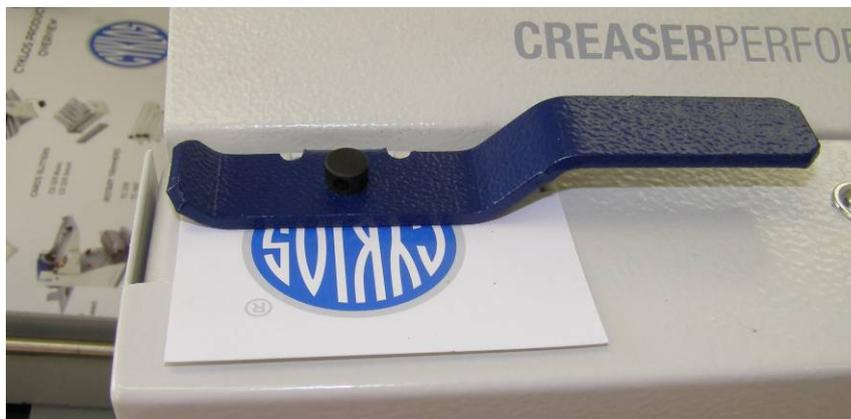
**Image 18 :** On délimite l'écart du système d'alimentation de friction en mettant le papier au-dessous du callipers
